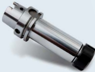
DUAL CONTACT ER COLLET CHUCK DIN 69893/ISO 12164-1-HSK FORM A
